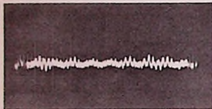
Afb. 10. Oscilloscoopbeeld van het uitgangssignaal van de converter gedurende de stand-by positie van een facsimile zender (b.v. DCF 37). De 1800 Hz hulpdraaggolf, welke aan de vermenigvuldiger van de converter wordt toegevoerd, vertoont een minimum amplitude (wit). Soms (o.a. bij Franse meteorologische facsimile stations) vertoont het oscilloscoopbeeld tijdens de stand-by positie een maximum amplitude (zwart).
